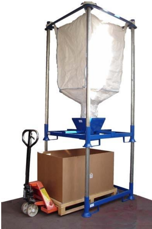
TOLVA DE VACIADO DE BIG BAGS.
