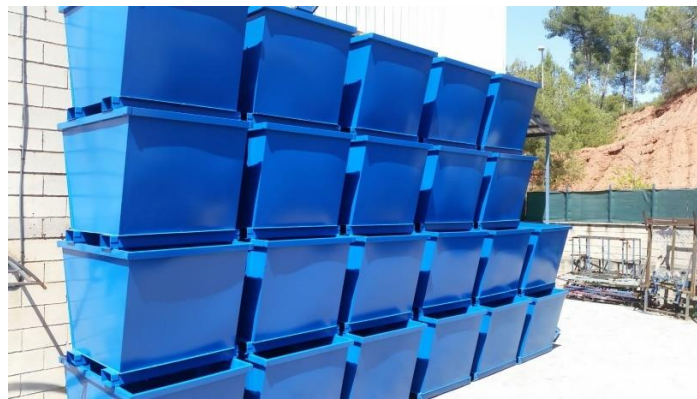
Contenedor apilable y volteable con pasa palas de tubo y troncocónico para facilitar El vaciado total de la contenido. Fabricado en chapa de 3 mm. Gran resistencia.
